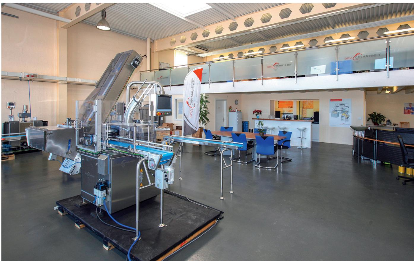
In einem großzügig dimensionierten Show-Room werden Interessenten diverse Anlagen gezeigt. Im Bildvordergrund sind eine Dosen-Verschließmaschine Matic 99 und links daneben ein Capper des Typs C 127 mit Schrägförderer zu sehen. (Fotos: Kimberly Wittlieb)
