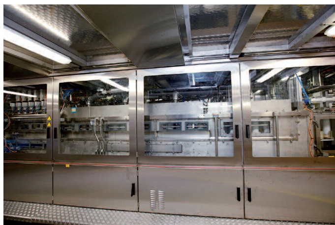
Wesentliche Neuentwicklungen der A6 iLine sind die Spritzguss-Sektion, die Vorheiz-Strecke und die spezielle Aseptik-Kammer
