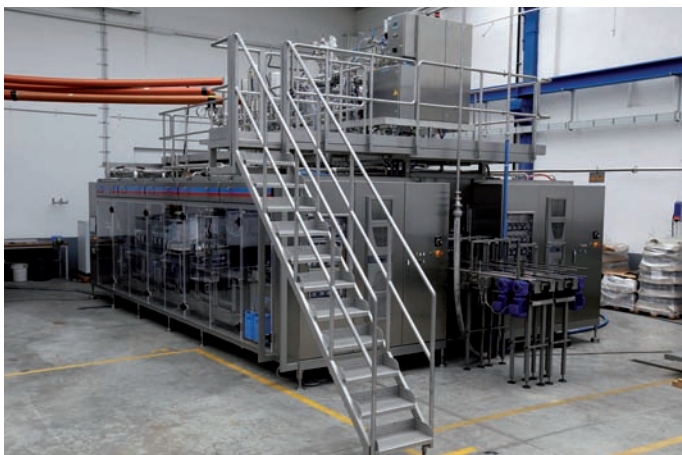
Die aseptisch, linear arbeitende Flaschen-Füll- und Verschließanlage Innosept Asbofill ABF 711 Twin ist quasi eine Kombination zweier Single-Maschinen
