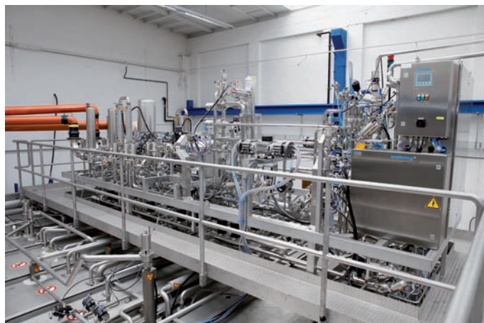
Die beiden Linearfüller werden aus nur einem Ventilknoten versorgt
