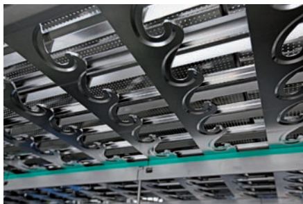
Die Zellenleisten, welche die Flaschen am Neckring aufnehmen und durch die Aseptikzone transportieren
