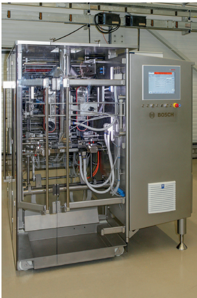
Vertikale Schlauchbeutelmaschine SVC 2620 mit Kantensiegelungs-Funktion
