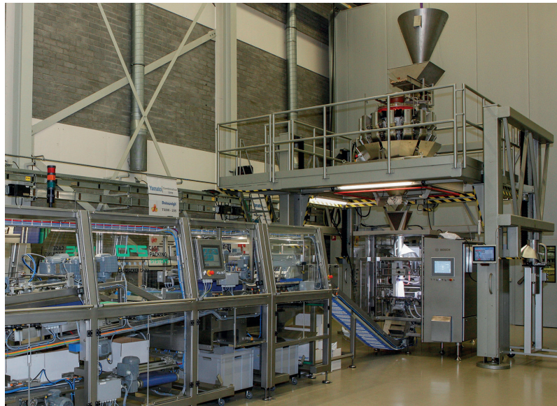
Komplettlinie mit vertikaler Schlauchbeutelmaschine SVC 4020 von Bosch Packaging Technology, Yamato-Mehrkopfwaage der Omega-Serie und Case Packer CP 201 von CPS
