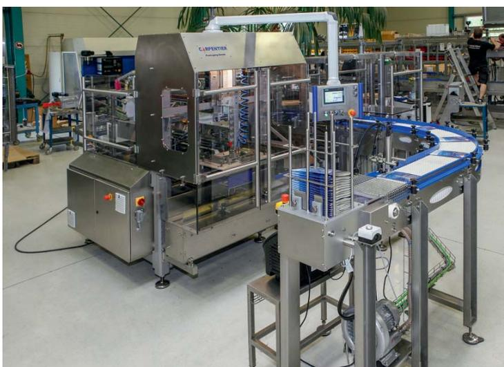
Kurz vor der Auslieferung: eine Linie mit Aufrichter, mechanischem Toploader und Verschießer
