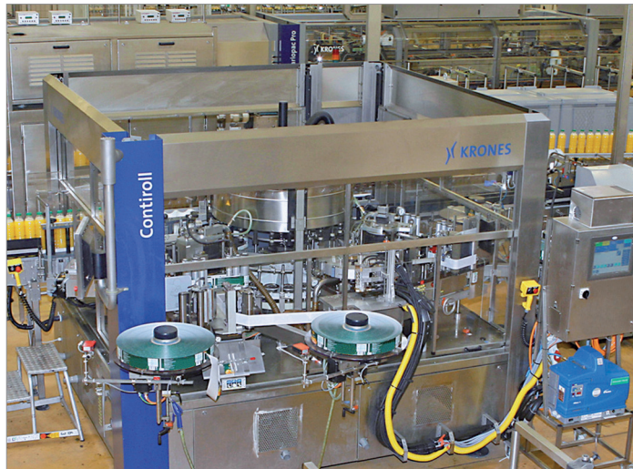
Die Umrüstung erfolgte zunächst an einer der Etikettiermaschinen der insgesamt drei Abfülllinien der PET-Halle.
