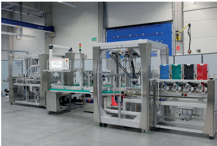
Gesamtansicht der Palettentransfer-Blistermaschine KBS-PT mit integriertem Delta-Roboter KRH-D
