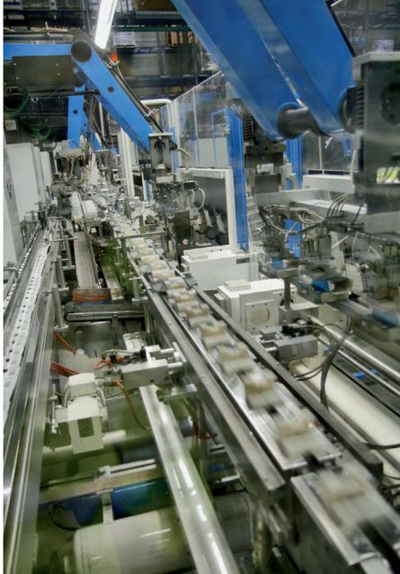
Mit hoher Geschwindigkeit durchlaufen die Tintenpatronen respektive Schachteln die Stationen Aufrichter, Füller, Einleger, Verschleißer und Übersetzer.
