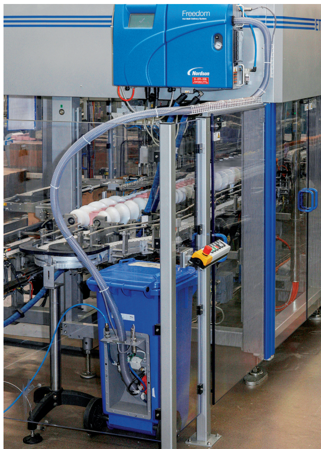
Der Freedom-Melter und der grosszügig dimensionierte Vorratsbehälter bilden ein geschlossenes System.
