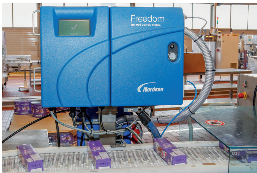
Das tanklose Hotmelt-Auftragssystem Freedom ist in Kopfhöhe über dem Produktaustragband installiert.
