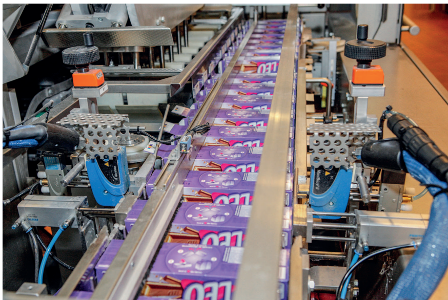
Zwei selbstreinigende Auftragsköpfe des neuen Typs MiniBlue II SureBead setzen je zwei Klebepunkte auf jeder Seite.
