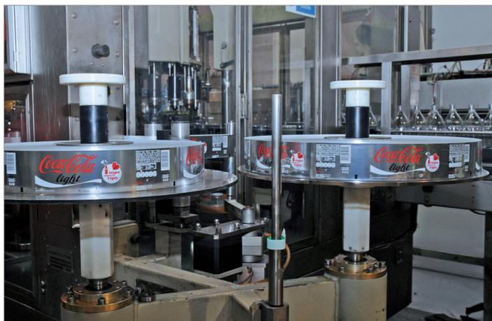
Die Zuführung der Etiketten erfolgt aus Rollenmagazinen.
