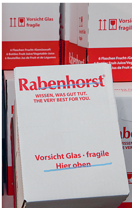
Zwei circa 11 Zentimeter lange Hotmelt-Raupen – im Bild zur besseren Visualisierung blau eingefärbt – gewährleisten eine rutschfeste Palettierung.
