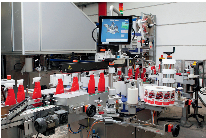
Die neue Formflaschen-Etikettier-anlage in der Gesamtansicht.
