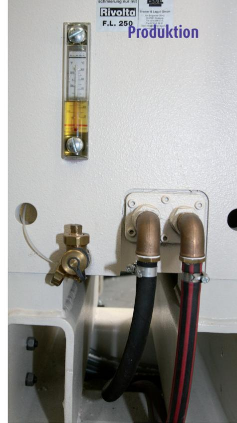
**Das NSF-H1-klassifizierte Schmieröl F.L. 250 wird an verschiedenen Getrieben genutzt**
