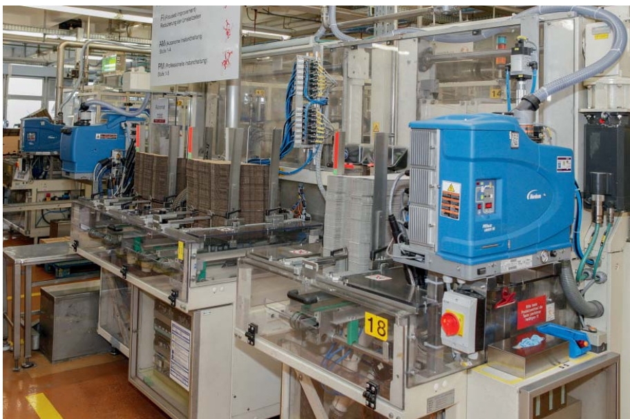
An einem doppelbahnig ausgelegten Sammelpacker sind zwei ProBlue Liberty-Systeme installiert. Im Hintergrund ist ein drittes Gerät an einer weiteren Verpackungsmaschine zu sehen
