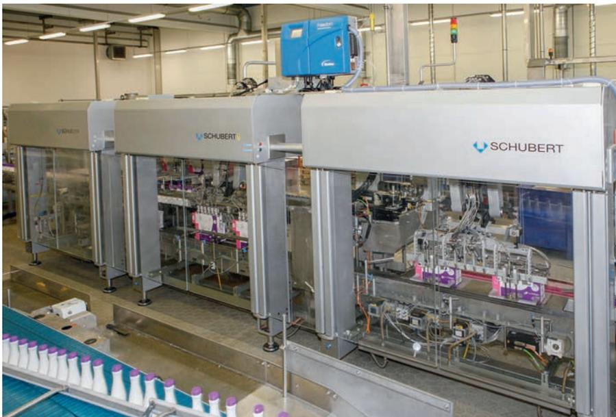
Eines der beiden neuen Freedom-Systeme wurde über Kopf mittig auf der Verpackungsmaschine platziert. Das andere, für die Bodenverklebung zuständige ist – im Bild nicht sichtbar – ebenerdig links auf der Rückseite der Anlage im Produkteinlaufbereich installiert.
