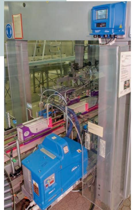
Als Abschluss des Verpackungsvorgangs werden zur Paletten-Transportsicherung zwei Längsraupen appliziert, deren Auftrag von der neuen Klebstoffauftragsmuster-Steuerung Spectra 30 – im Bild rechts oben – kontrolliert wird.
