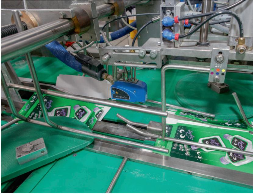
Die Verklebung der Fabrikante bewerkstelligt ein vollisolierter pneumatischer Applikator des Typs MiniBlue II Slim Line.
