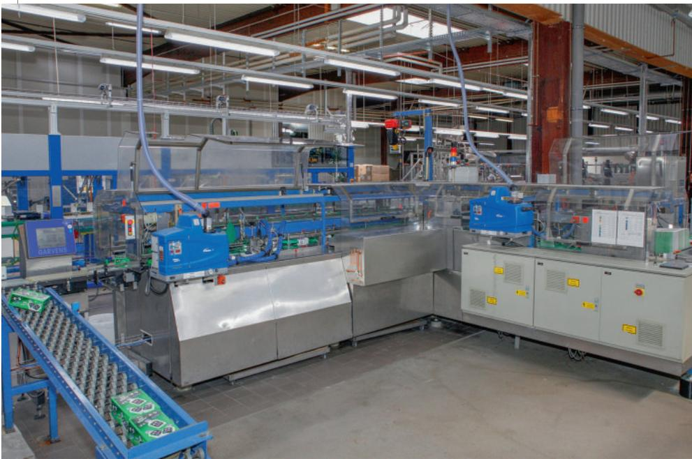
Die Verpackungsmaschine - zur besseren Visualisierung links mit geöffneter Haube - mit den beiden neuen, in Brusthöhe montierten Hotmelt-Auftragssystemen ProBlue Liberty in der Gesamtansicht.
