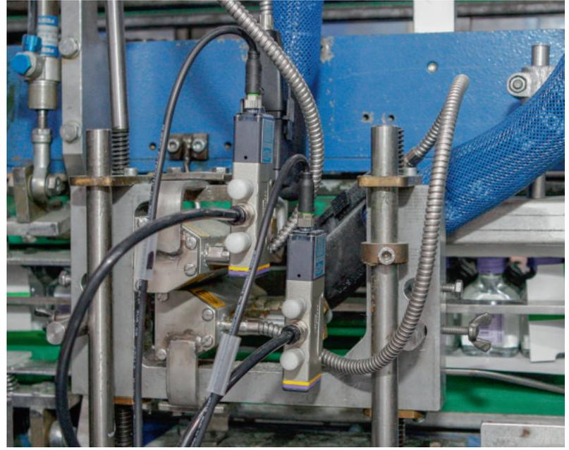
Die Endverklebung der Verkaufskartons geschieht auf beiden Seiten mit Hilfe von zwei mehrmoduligen Auftragsköpfen des Typs MiniBlue II LP.
