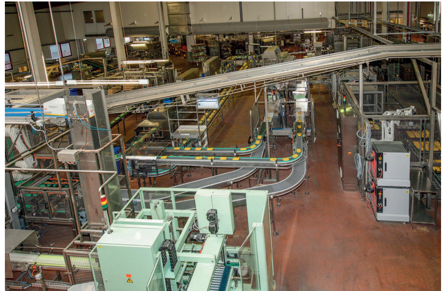
In der Draufsicht auf die gesamte Verpackungsanlage ist die zwei-bahnige Konzeption der Anlage gut erkennbar. Durch das Querförderband etwas verdeckt sind der Aufrichter (Bildmitte hinten) und der Verschleißer (halblinks).
