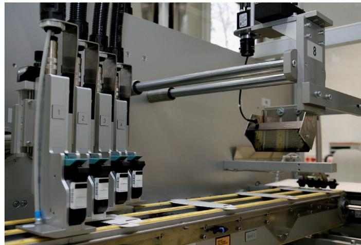
Das Herzstück der Anlage ist die Drucksektion mit vier verfahr- bzw. kaskadierbaren Druckköpfen und der Druckkontrolle via Kamera.
