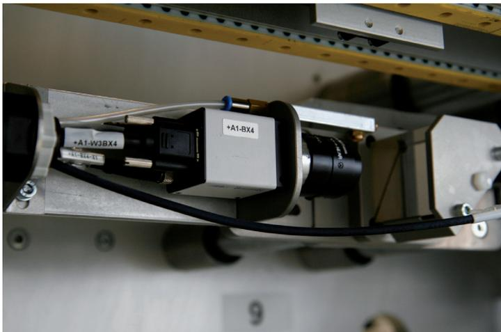
Zur technischen Validierung ist unterhalb des Vakuum-Transportbands eine weitere Kamera installiert.
