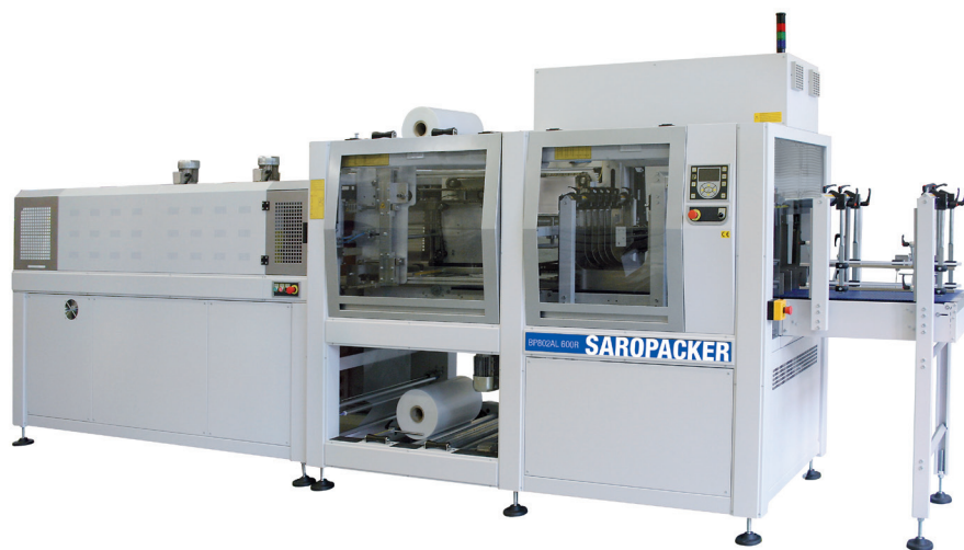
SAROPACKER XP650 ASX, Inline Bündelpackmaschine mit Folienüberlappung
