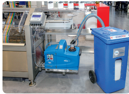
Tankloses Hotmelt-Auftragungssystem Pro-Blue Liberty 7 mit – in diesem Fall separat weiter oben am Auslauf der Maschine installiertem – Klebstoff-Durchflussmesssystem ATS und Heißbleim-Vorratsbehälter.
