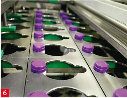
**4. Auf der Füll- und Verschließmaschine können verschiedenste Neckdurchmesser und Flaschengeometrien gehandhabt werden.**
