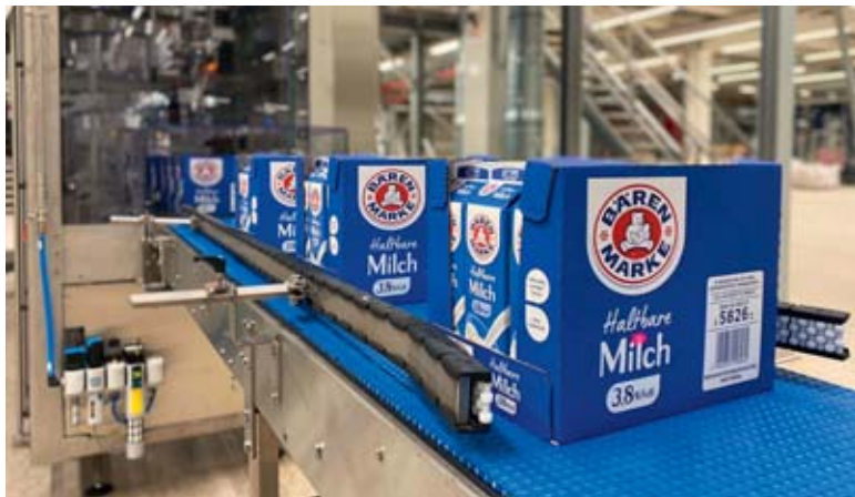
In Wrap-around-Trays verpackte 12er-Gebinde auf dem Weg ins Hochregallager.
