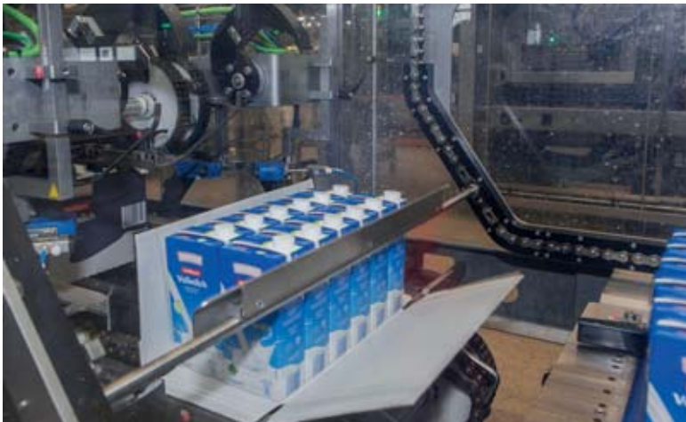
Die Tray-Verklebungsstation des Meurer-Kartonierers.
