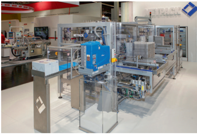
Die von Meypack auf der Fachpack 2015 vorgestellte Kartonverpackungsanlage VP 453 mit einem in Vordergrund zu erkennenden Hotmelt-Auftragungssystem ProBlue Liberty von Nordson. Aus optischen Gründen wurde das Granulat hier – abweichend von der betrieblichen Praxis – nicht aus einer Vorratsstonne, sondern aus einem transparenten Behältnis zugeführt.
