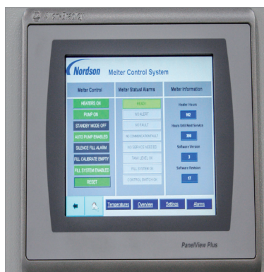
Abb. unten rechts: Das neue Hotmelt-Auftragungssystem ProBlue Liberty 7 ATS mit integrierter Klebstoff-Durchflusskontrolle
