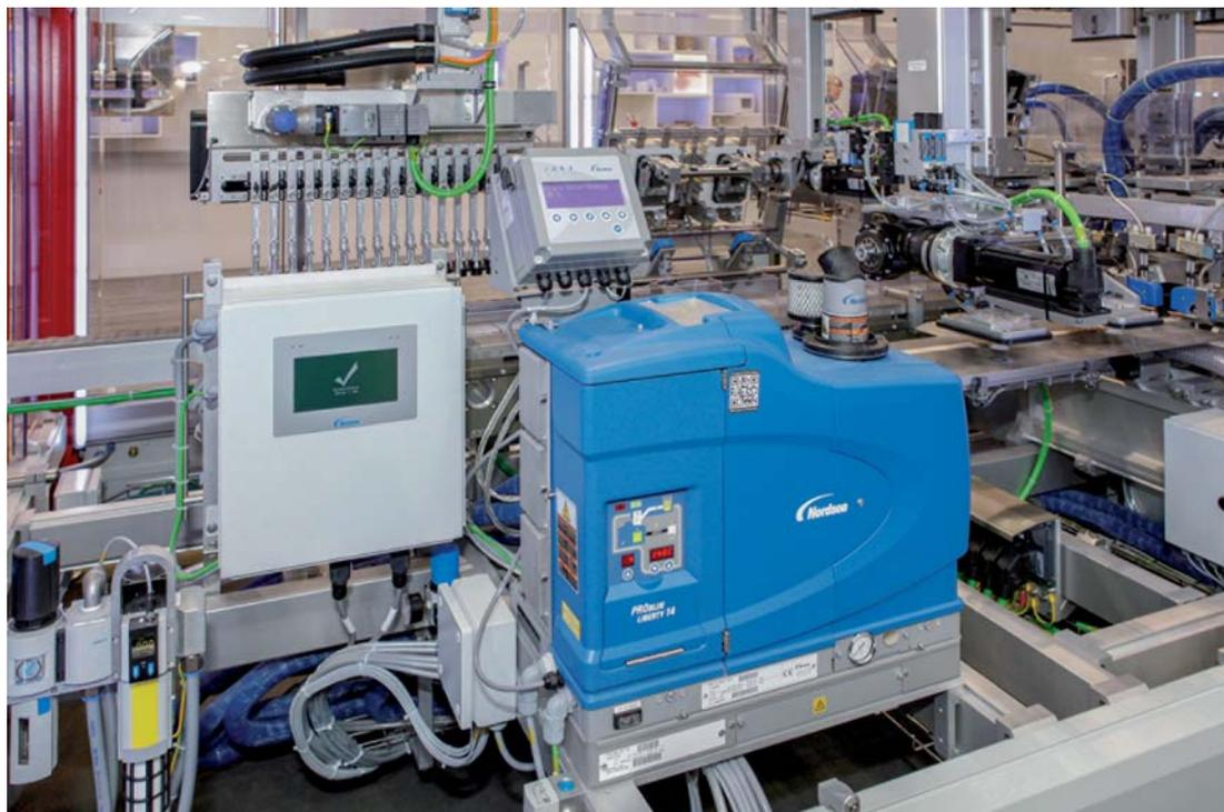
Sein signifikantestes technisches Merkmal ist – neben der Klebstoff-Durchflusskontrolle – der Verzicht auf ein herkömmliches Tanksystem. Stattdessen wird in dem volumenreduzierten Reservoir der quasi wie ein Durchlauferhitzer arbeitenden Schmelzeinheit nur die tatsächlich benötigte Klebstoffmenge auf Verarbeitungstemperatur gehalten.
