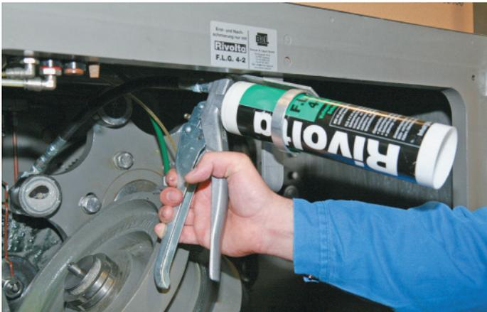
Das H1-zugelassene Wälz- und Gleitlagerfett F.L.G. 4-2 wird mithilfe einer Handpresse in die Schmiernippel der Kurvenrollen eines Dornradteils eingebracht
