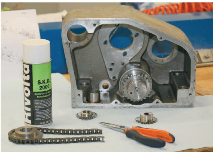
In der Werkstatt wird u. a. der Hochleistungs-Haftschiemstoff S.K.D. 2000 zur Kettenabschmierung – hier eines Getriebegehäuses – eingesetzt
