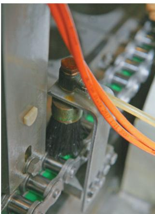
Das H1-Öl F.L. 1000 wird aus der Zentralschmierung auf einen Pinsel hochgepumpt und dient somit auch zur Schmierung der Rollgliederketten
