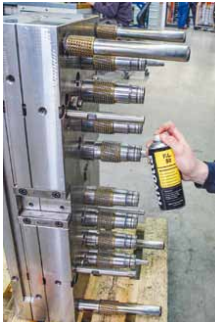
▲ Im Werkzeugbau werden die Rollenlager mit einem NSF H1-klassifizierten Sprühöl geschmiert.
