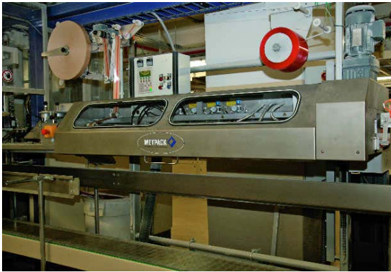
Die neuere der beiden bis auf die Durchlaufrichtung identischen FTS-Sackverschleißmaschinen. Links oben befindet sich das Siegelband, in welches das oben rechts erkennbare Aufreißband eingearbeitet wird.
