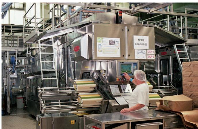
*Abfüllung von gentechnikfreier Frischmilch in 1,5-Liter-Kartons auf einer Anlage mit einer Kapazität von 9.000 Einheiten pro Stunde im Kölner FrieslandCampina-Werk*
