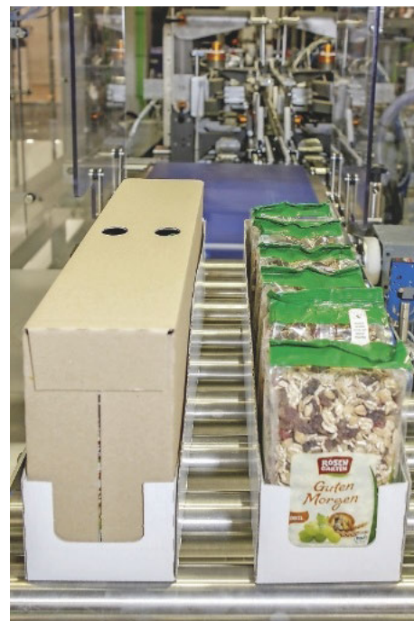
Auf der Fachpack 2015 wurden auf dem Deckel-Tray-Packer KWH-DT Produkte des Bio-Cerealienproduzenten Lebensgarten verpackt. Nach der Fachschau ging die Messemaschine an das Unternehmen. (Foto: Kimberly Wittlieb)
